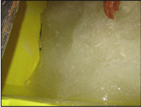
Figura 27. Pasta de papel reciclado con fibras vegetales triturado en la batea. Foto: Jacqueline Joseau.
