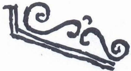
16.15. Alberti, detalle de una carta dirigida a Matteo de' Pasti, 18 de noviembre de 1454. Alberti insertó en el texto de su carta a Mateo de Pasti un boceto de este detalle, para indicarle cómo realizar la transición entre las naves laterales bajas y la nave central alta.
